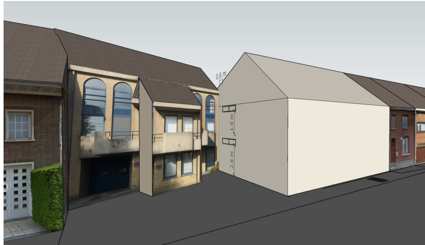
illustratie m.b.t. lichten en zichten bij het bouwen op de zijdelingse perceelsgrens of op minder dan 1,90 m van de zijdelingse perceelsgrens
