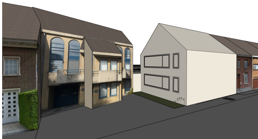
illustratie m.b.t. lichten en zichten bij niet bouwen op de zijdelingse perceelsgrens (afstand van 1,90 m)
